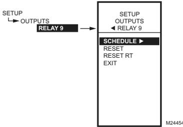
Fig. 46. Setup - Outputs - Relay Menu.
