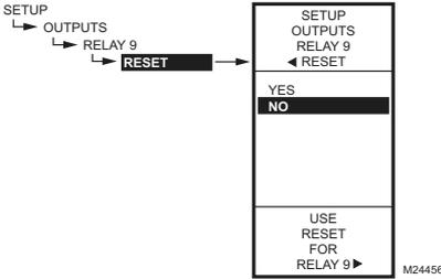
Fig. 48. Setup - Outputs - Relay - Reset.
