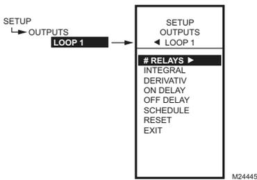
Fig. 37. Setup - Outputs - Loop 1 Menu.
